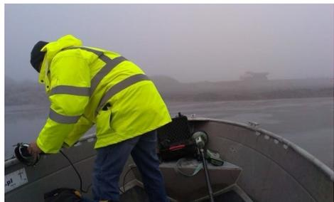
Batimetría de la presa de Raziborz - Polonia (Leica 1200 + sonda OHMEX SonarMite V4.0MTX).
